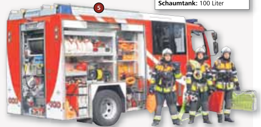
Tunnelfahrzeug Rankweil Wassertank: 1500 Liter Schaumtank: 100 Liter
